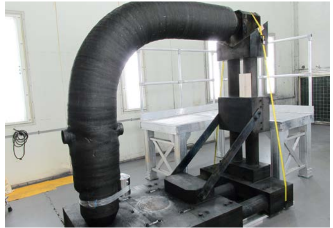
CMC-armierter Stahl-Rohrleitungsbogen in der Haltekonstruktion für die Ofenpyrolyse.
