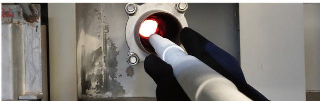
Messlanze zur Inline-Detektion von Temperatur und Ofenatmosphäre
