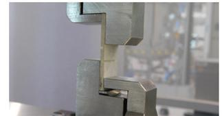
Scherversuch mit doppelgekerbter Probe
