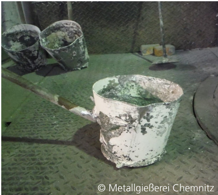
Gießtiegel (links) und Rinne aus Glasfaser-Aluminiumsilikatmatrix (rechts) für die Verarbeitung von Metallschmelzen in Gießereien
