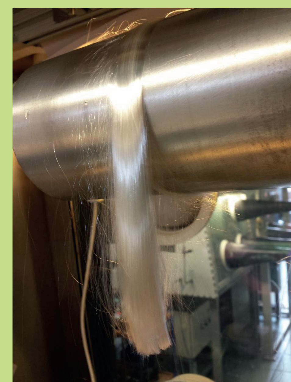
Grünfaserbündel hergestellt über das Langfaserspinnverfahren
