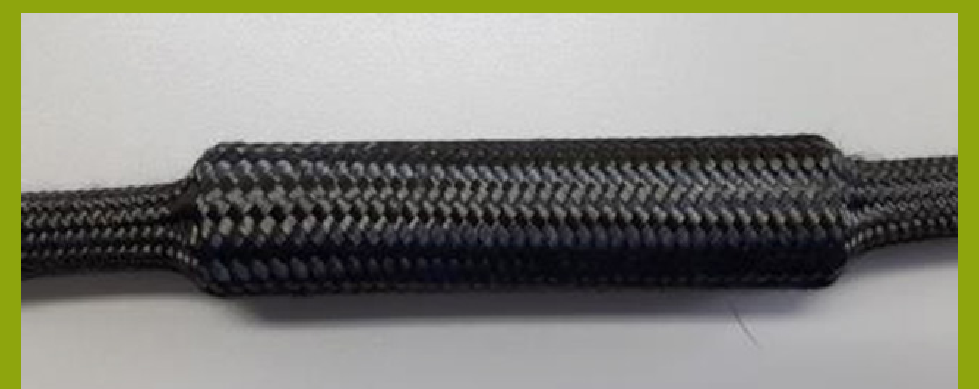
Textile Flechtstruktur als drapierbare Faserpreform aus hochsteifen Fasern
