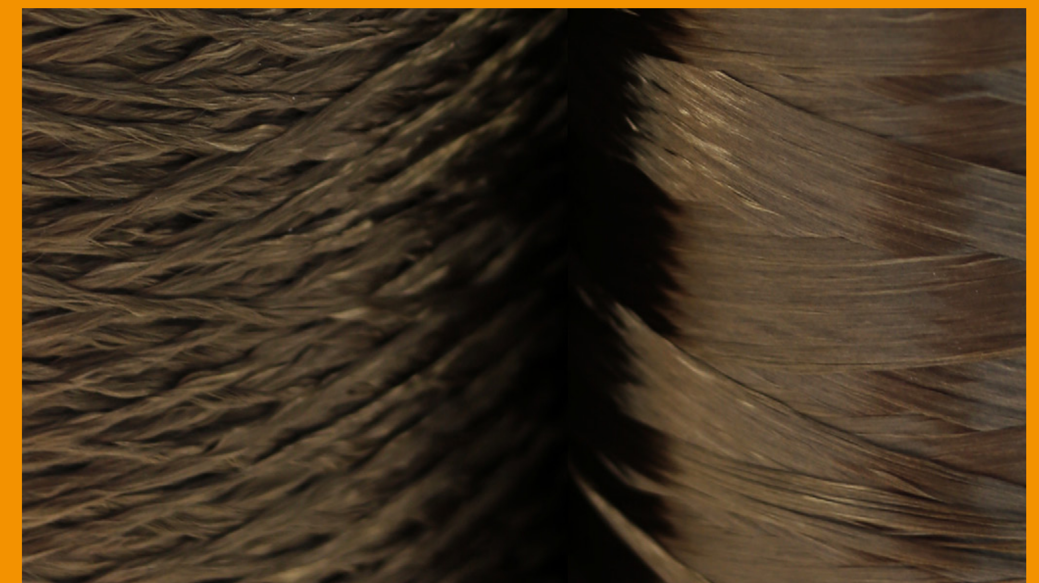
Texturierte (links) und glatte (rechts) Basaltrovings als Ausgangsmaterial
