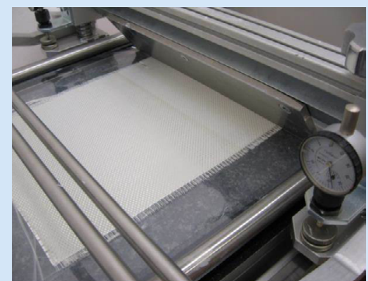
Rakeleinheit zur Infiltration von Keramikfasergeweben mit Suspensionen
