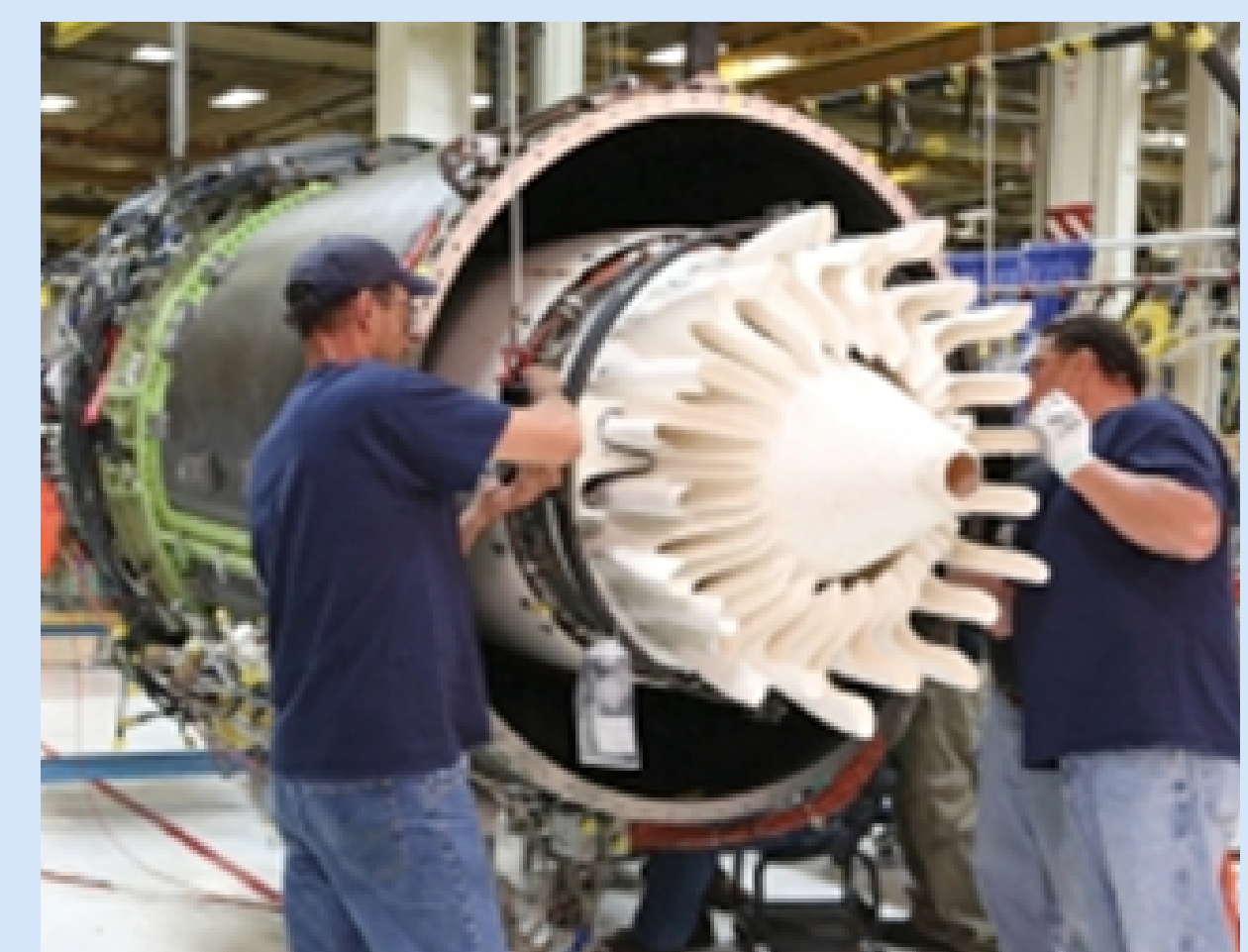
Abgasmischer aus oxidischen CMC für Fluggasturbinen bei der Montage (Quelle: www.ainonline.com/aviation-news/nbaa-convention-news )
