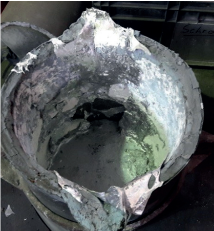
Abbildung 10: Gebrauchter Gießtiegel mit Keramikgewebeaufkleidung.
