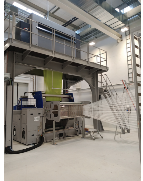
Abbildung 3: Doppelgreifer-Webmaschine mit Einzelfadenbetrieb.
