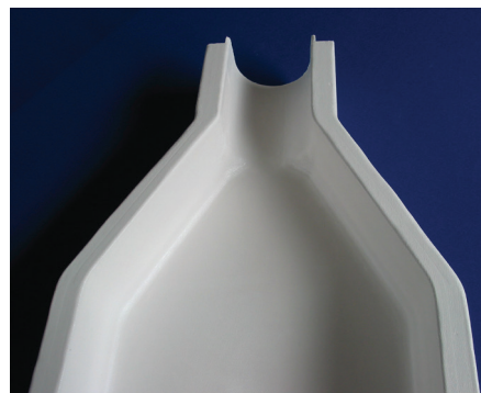
Abbildung 7: Glasfasern verstärken die Gussrinne. Quelle: InovaCeram
