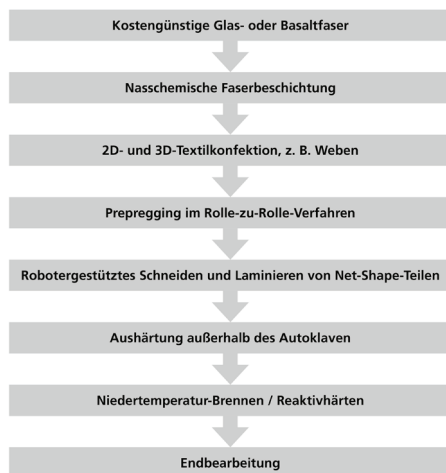
Abbildung 1: Prozesskette zur Herstellung von Low-Cost-CMC in einem geschlossenen Prozesskreislauf.
