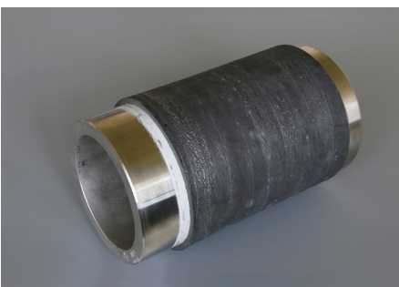
Abbildung 11: CMC-Bewehrung für Kraftwerkstahlrohre. Quelle: Fraunhofer-Zentrum HTL
