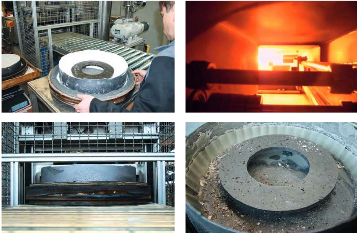
Bild 3 Herstellung von C/C-SiC-Bauteilen mittels induktiv beheiztem Schnellsintersystem: a) Vorbereitung des Tiegels mit C/C-Preform zum Einschleusen in Vakuum-Vorkammer; b) Öffnung der Schleuse zur Silizierkammer nach 30 min; c) Ausstoß des Tiegels mit Bauteil nach 38 min aus der Abkühlkammer; d) siliziertes Bauteil im Tiegel
