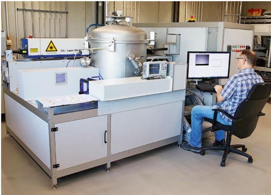
**Bild 6** ThermoOptische Messanlage TOM\_wave für die Hochtemperatur-Charakterisierung thermomechanischer Eigenschaften. (© Fraunhofer-Zentrum HTL)
