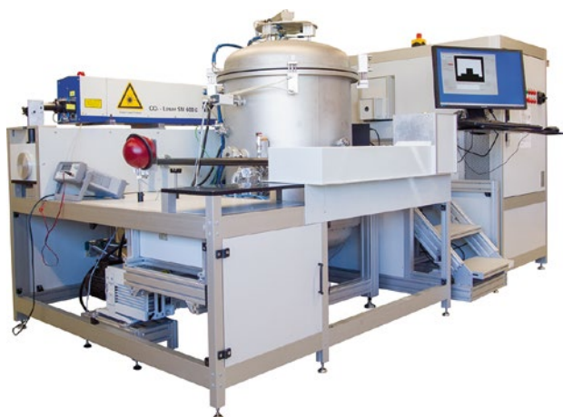
Bild 2 Thermooptische Messanlage TOM_wave (links) sowie schematische Darstellung der Messmodi (rechts) © Fraunhofer-Zentrum HTL
