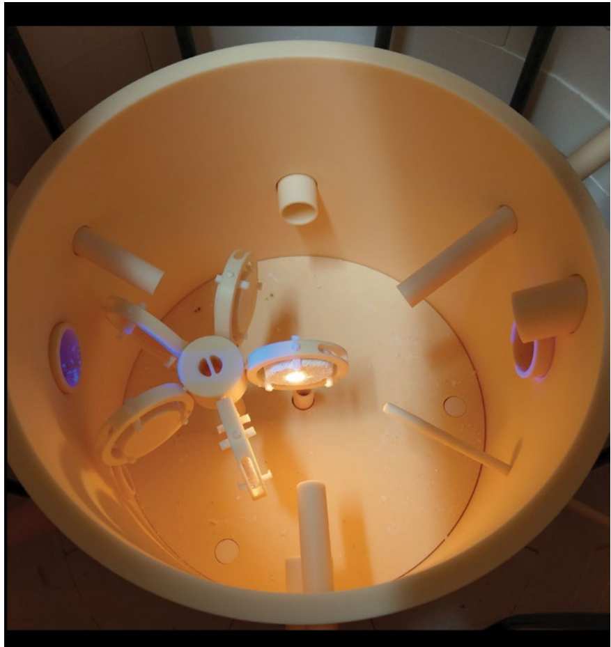
Bild 4 Probenhalter und Muffel von TOM_wave (© Fraunhofer-Zentrum HTL)
