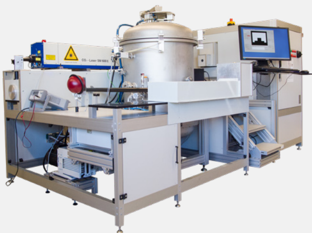
Bild 5: ThermoOptische Messanlage TOM_wave (links) sowie schematische Darstellung der Messmodi (rechts)
