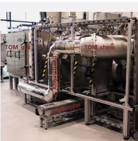
Bild 6: Korrosionsprüfstand TOM_chem (links) sowie Prinzipschema zum Gasfluss (rechts)
