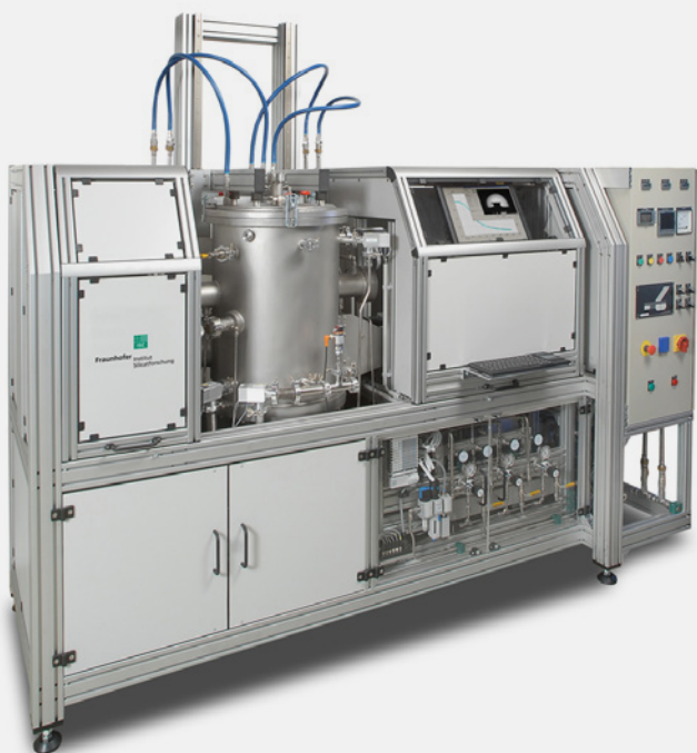
Bild 3: ThermoOptische Messanlage TOM_ac zur In-situ-Messung von Wärmeprozessen in inerter und reduzierender Atmosphäre
